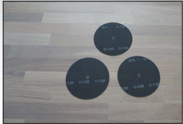
Abb. 9 Feine Oberfläche nach dem letzten Schleifgang mit TRIO und Schleifgitter Körnung 120.
