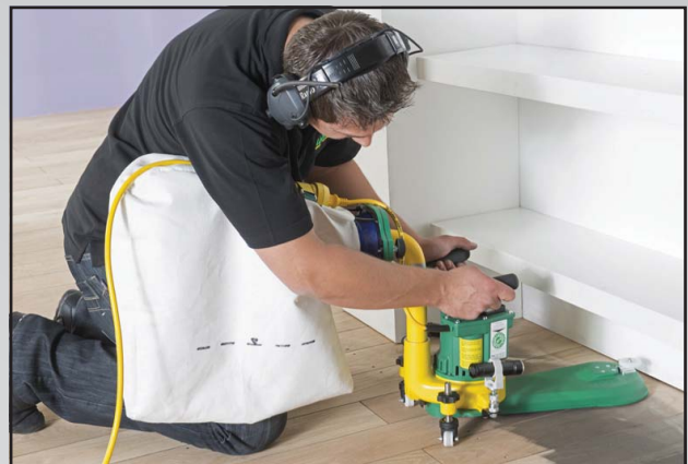
Abb. 11 Die FLIP® beim Schleifen mit langem Vorsatz
