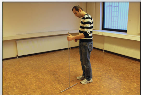
Abb. 6 Prüfung der Haftung auf dem Untergrund
